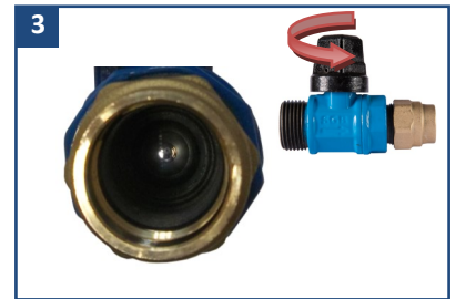
Manœuvrer le robinet d'un quart de tour pour mettre la sphère en position fermée. (sens de fermeture FAH)
